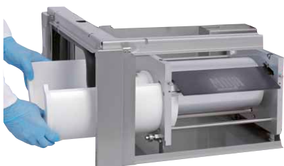
Bei den Modellen SAH 85 - 500 und RVH 250 wird die Wasserwanne seitlich herausgenommen.
