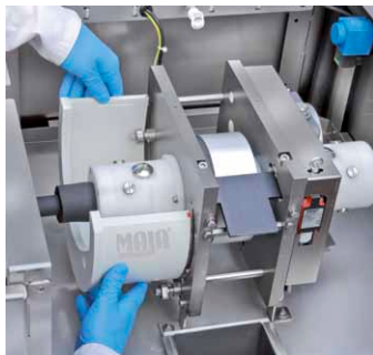
Ausbau der Wasserwanne zum Reinigen
